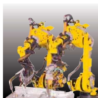
スポット溶接
